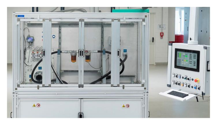
O sistema hidráulico especial e os instrumentos de medição utilizados são capazes de mensurar e registrar o potencial elétrico gerado quando um filtro é atravessado por um fluxo de óleo, mensurado em kV.
