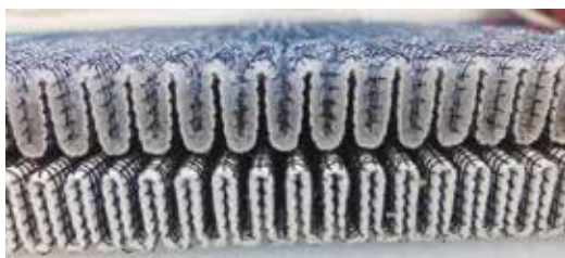
O meio filtrante tem água absorvida
