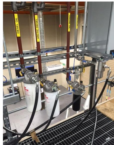
Filtros em linha LMP 210 e MPS Spin-on para diesel, óleo de motor, fluido Adblue
