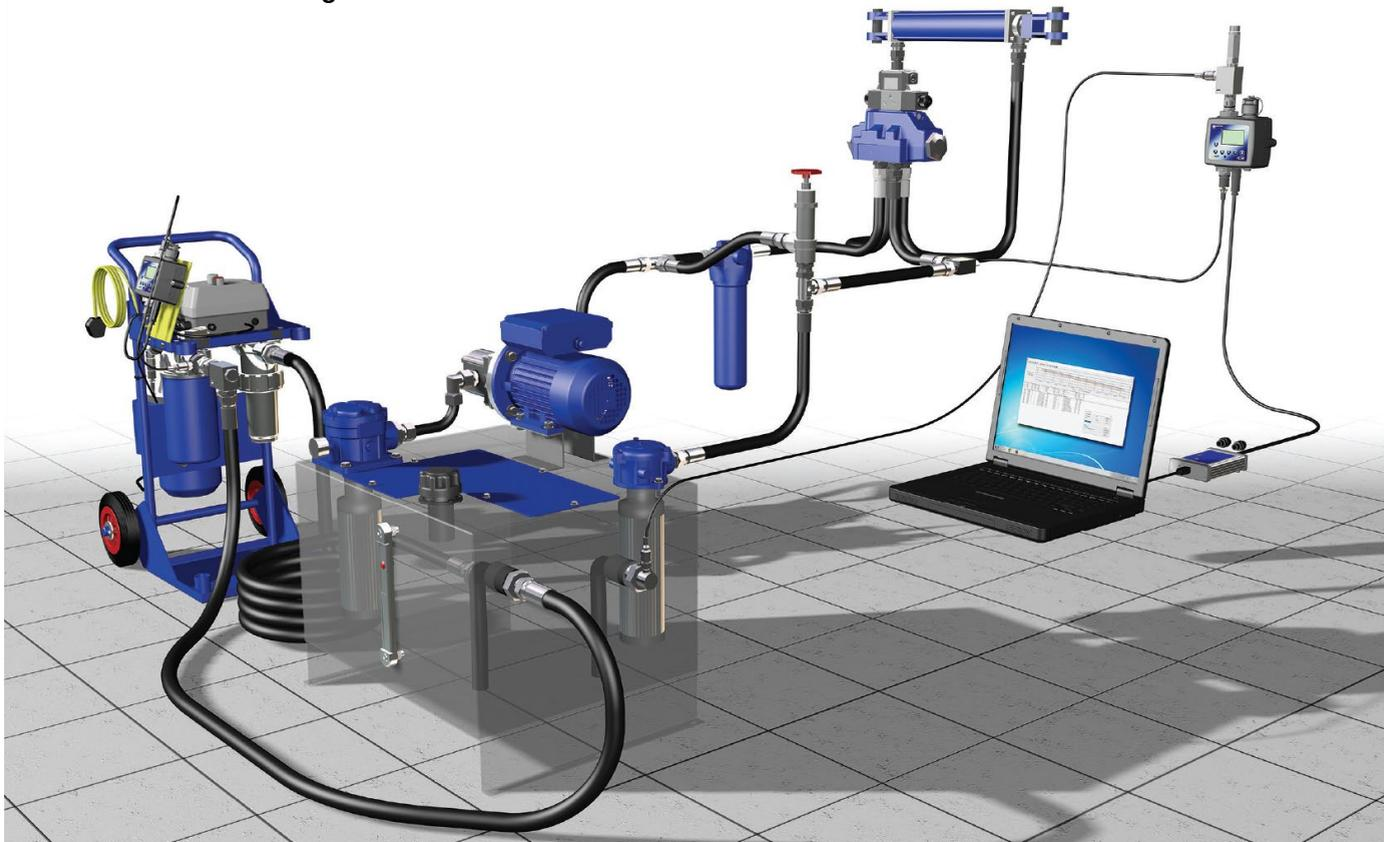
**Para manter a limpeza do fluido, é essencial o uso de filtros para remover quaisquer contaminações que ainda possam restar no sistema.**
